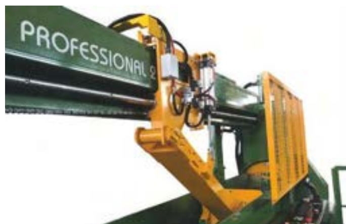
Podnośnik z popychaczem z systemem mechanicznym/pneumatycznym
