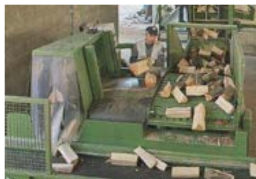
11 Tonowa stacja łupiąca, kasetą na 2+4 części
