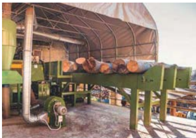
3-łańcuchowy stół podawczy, 4 metry długości
