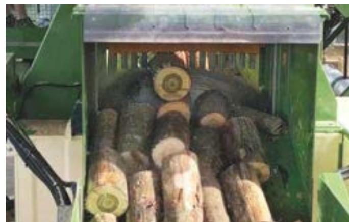
Mechaniczny system blokowania pni
