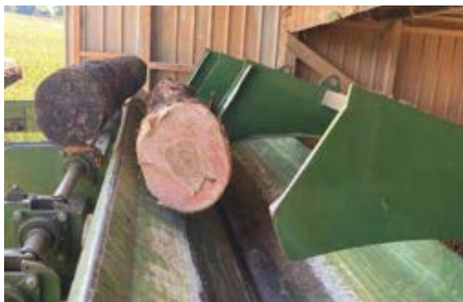
Ładowacz kłód z ramieniem amortyzującym
