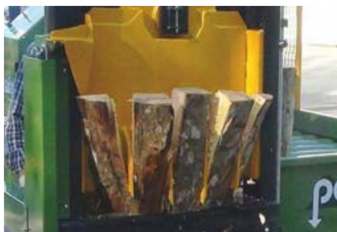
Klin z 4 orbitalnymi ostrzami produkujący 5 kłód na cykl
