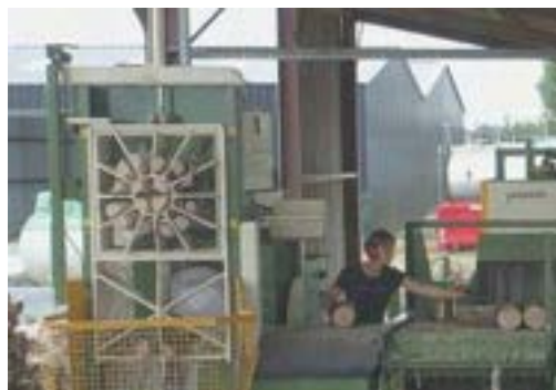
32 Tonowa stacja łupiąca, kasetą na 2+4+6+16 części
