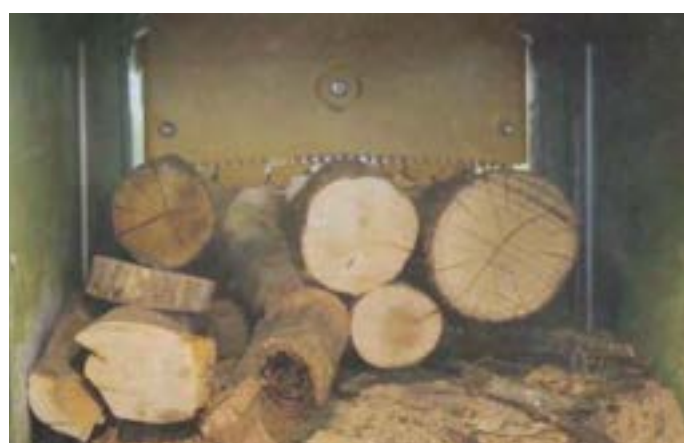
Łańcuchowa blokada drewna
