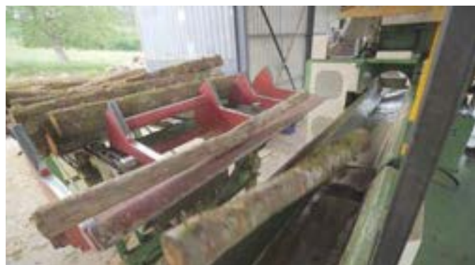
System ładowczy w kształcie półksiężyca
