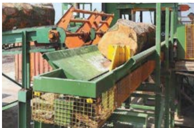
Rynna podająca z tylnym popychaczem
