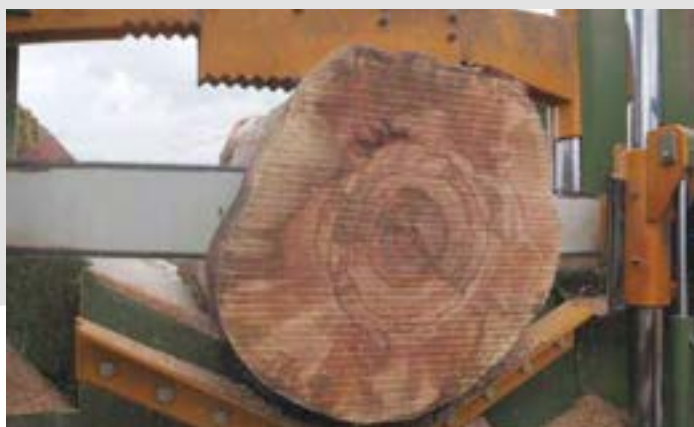
Poziomy przesuwny łańcuch odcinający
