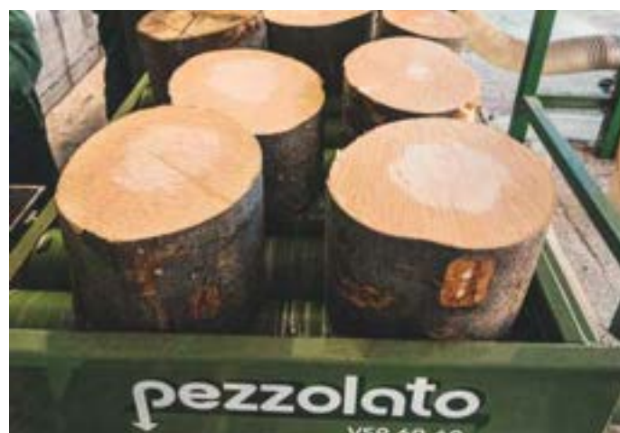
Stół ze zmotoryzowanymi rolkami do przenoszenia pociętych kłód
