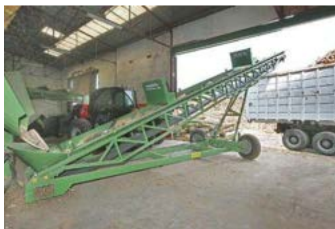
Napędzane kółka samonastawne sterowane hydraulicznie
