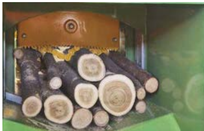
System blokady łańcuchowej. Skuteczny z różnorodnymi wiązkami drewna.
