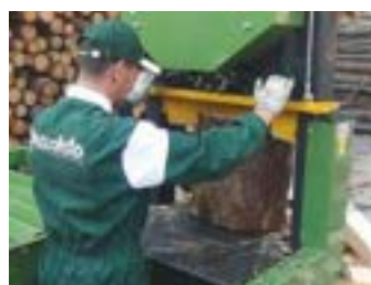
VS 60 - Zakrzywiony klin z 4 nożami orbitalnymi VS 60 - Podwójne ręczne sterowanie hydrauliczne
