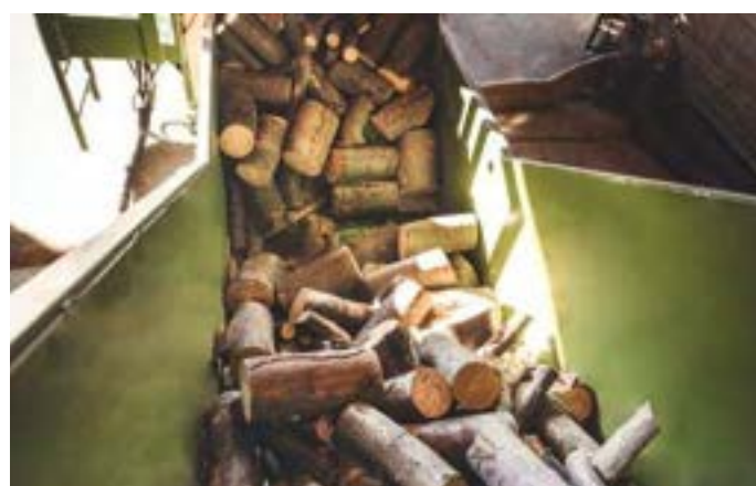
Przenośnik akumulacyjny do ciętego surowca
