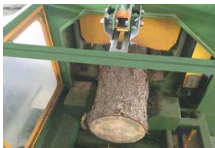
Fotokomórka do automatycznego pomiaru długości kłody
