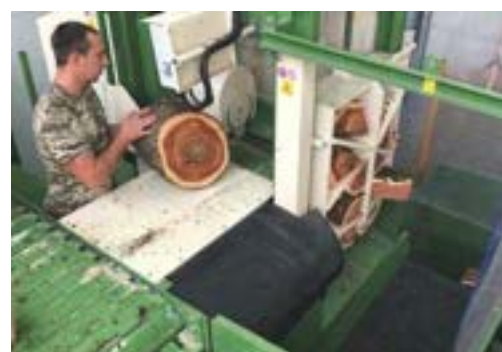
20 Tonowa stacja łupiąca, kasetą na 2+4+6 części
