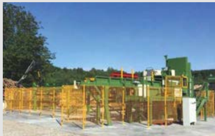
Bariery bezpieczeństwa do odgraniczenia obszaru roboczego
